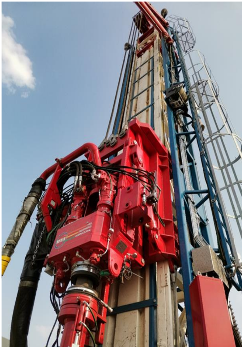
Бурение на обсадной колонне труб с извлекаемой КНБК
